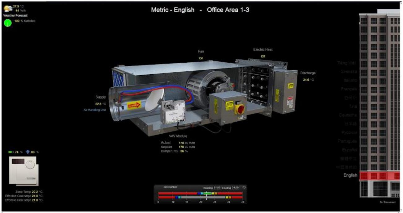
Figura 6: Grafica attiva per il controllo/monitoraggio di una cassetta VAV con indicazione del set point estivo/invernale
