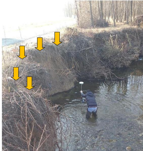
**Figura 13 – Sezione ove si è manifestata la massima erosione con arretramento del ciglio di sponda.**
