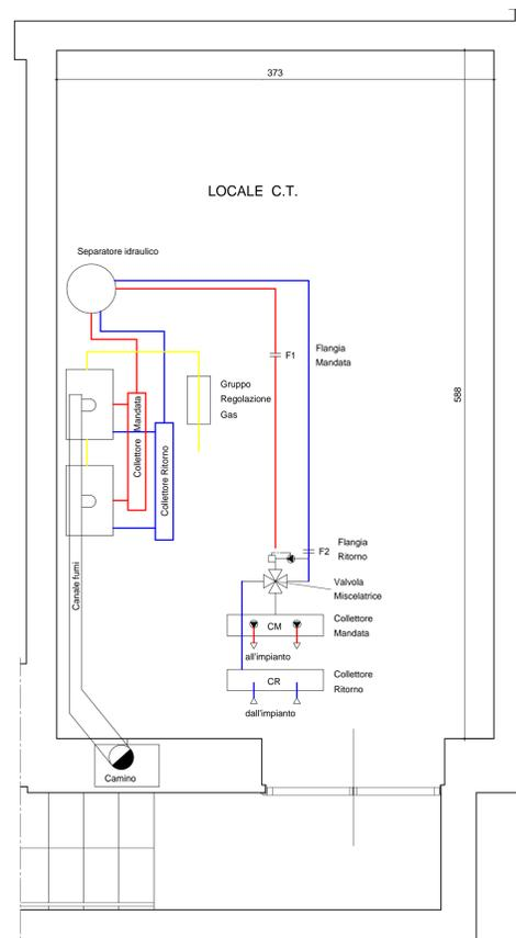
PROGETTO - PIANTA PIANO SEMI - INTERRATO - PARTICOLARE C.T. - SCALA 1:25
