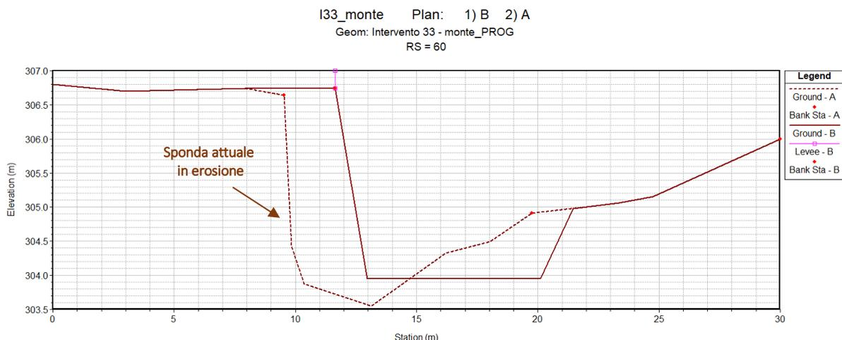
**Figura 12 – Tratto di monte: confronto sezione attuale e di progetto: interventi di riprofilatura e adeguamento planimetrico.**
