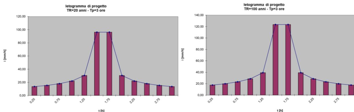
Figura 7 – Ietogramma Chicago definito in base ai coefficienti a ed n per Tr20 e Tr100 ed un tempo di pioggia pari 3h.
